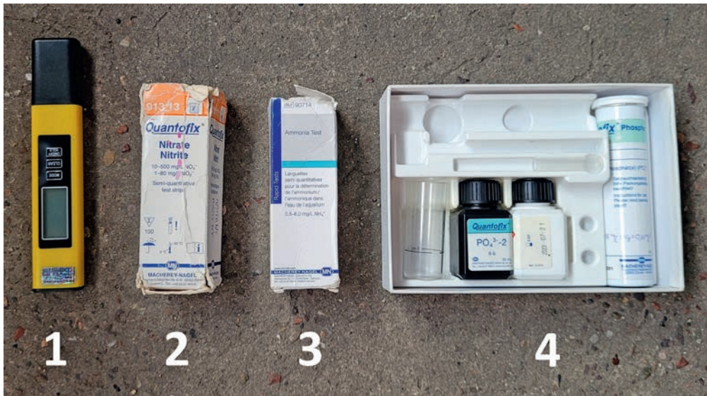
Fot. 1. Narzędzia do analizy wody mogące stanowić rozszerzenie możliwości SGRChem. Oznaczenia: 1 – kieszonkowy konduktometr, 2 – paski wskaźnikowe azotany/azotyny, 3 – paski wskaźnikowe amoniak, 4 – paski wskaźnikowe fosforany
