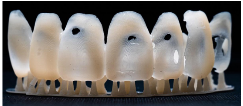
Ryc. 8. Nieprawidłowo zaprojektowana praca wydrukowana na warstwie o wysokości 50 µm
