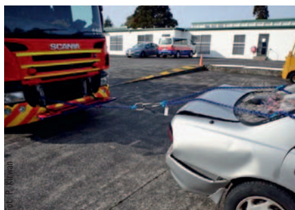
Fot. 1. Zakotwiczenie tylnej części pojazdu o pojazd ratowniczy (6)
