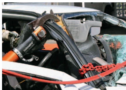
Fot. 2. Wykonanie naciągów słupków A (6)
