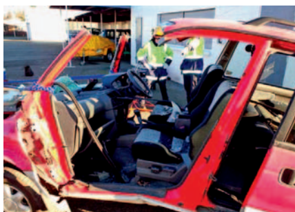
Fot. 4. Dostęp do poszkodowanego po otwarciu pojazdu (6)
