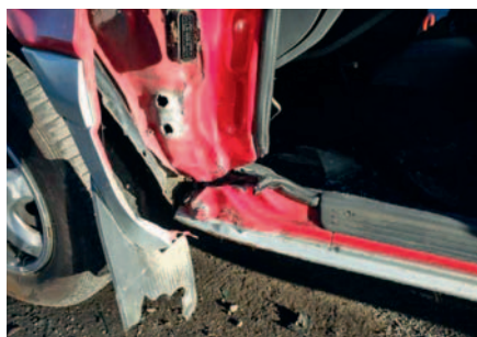
Fot. 3. Miejsce nacięcia słupków A u podstawy konstrukcji (6)
