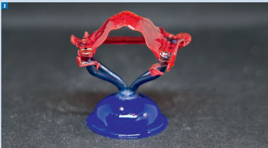
Fot. 3. Projekt systemu wlewowego zaprojektowanego dla protezy drukowanej z żywicy
