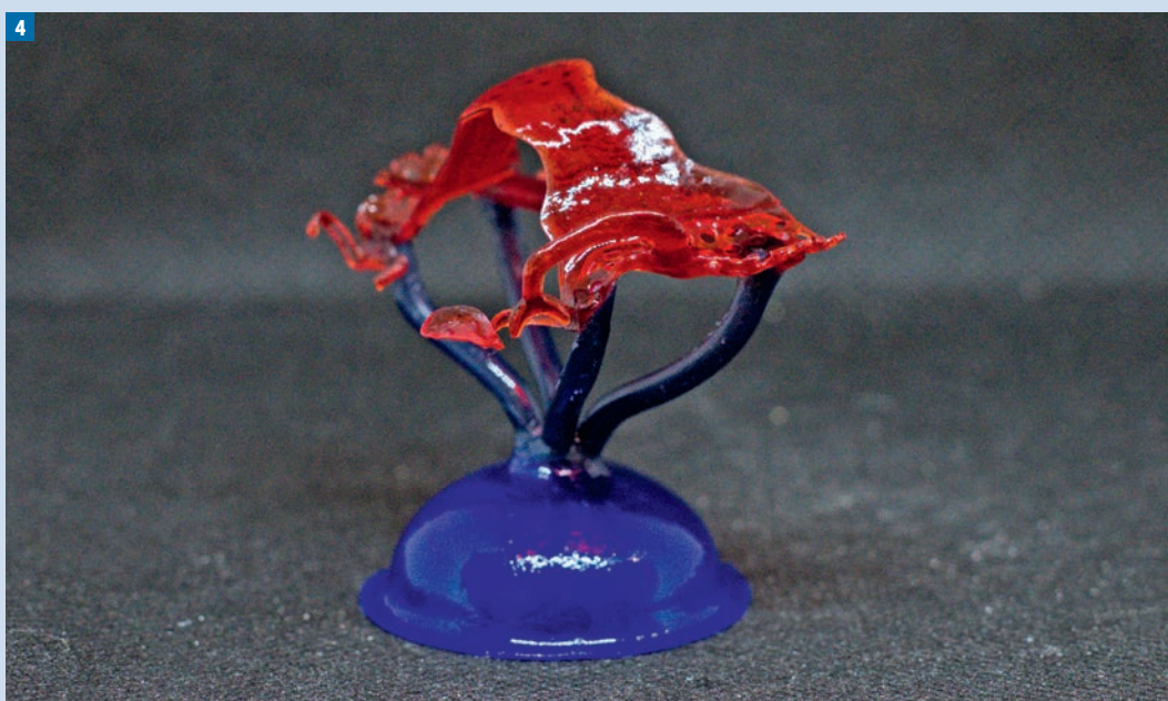
Fot. 4. Projekt systemu wlewowego zaprojektowanego dla protezy drukowanej z żywicy
