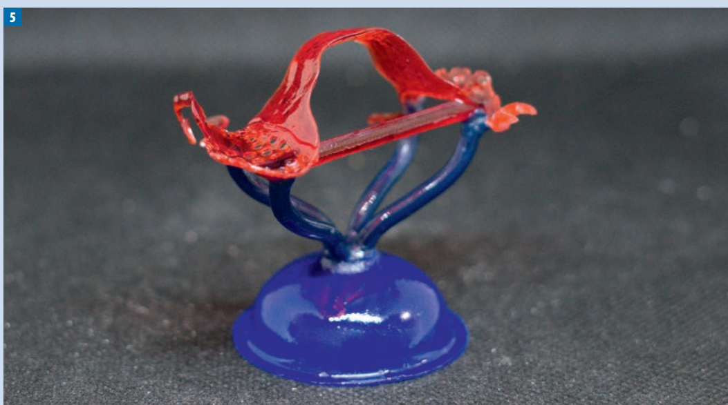
Fot. 5. Projekt systemu wlewowego zaprojektowanego dla protezy drukowanej z żywicy
