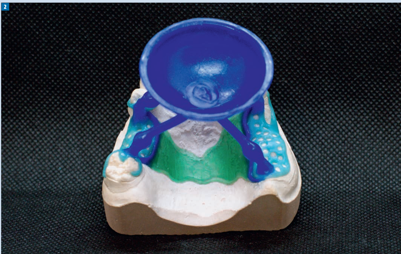
Fot. 2. Projekt systemu wlewowego dla protezy szkieletowej modelowanej z wosku
