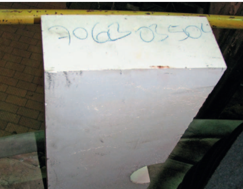
Fot. 4. Przycięta kształtka ceramiczna wstawiana w procesie platerowania. Z prawej strony wycięcie na elektrodę
