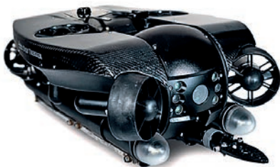
Fot. 2. Revolution ROV Deep Trekker z sonarem oraz manipulatorem; źródło: https://www.deeptrekker.com
