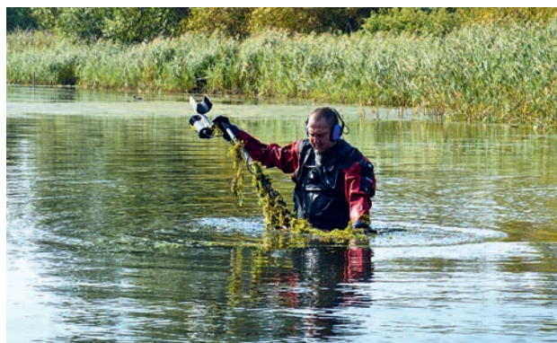
Fot. 1. Poszukiwania z wykorzystaniem magnetometru ręcznego Garrett Infinium LS (zakres pracy do 60 m głębokości); źródło: archiwum autora
