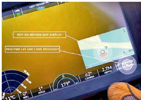
Fot. 3. Prowadzenie Revolution ROV Deep Trekker z sonarem oraz systemem nawigacyjnym przy niskiej przejrzystości wody (na monitorze sterownika widoczna mapa z pozycją ROV oraz odczyt sonaru w lewym dolnym rogu); źródło: https://www.deeptrekker.com
