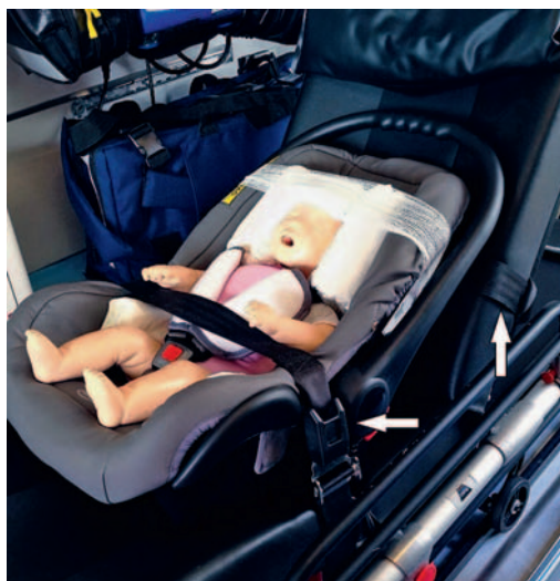
Fot. 2. Mocowanie fotelika samochodowego do noszy w karetce (białe strzałki wskazują pasy mocujące)
