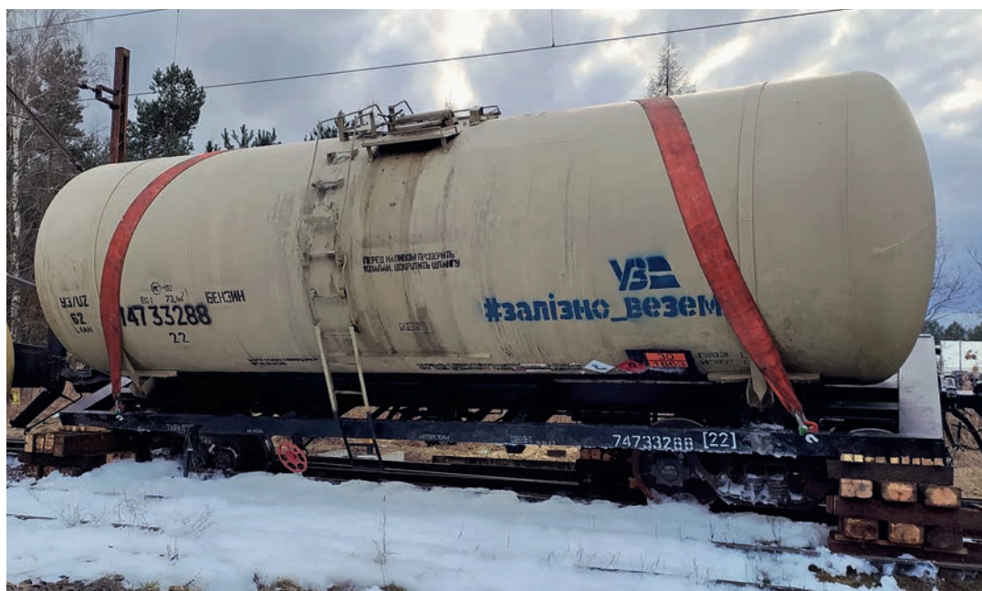
Fot. 5. Widok przechylonego wagonu zabezpieczonego zawieszami pasowymi trzymanymi przez wciągarkę hydrauliczną pojazdu SCDż 40 oraz podbudową drewnianą – z widocznej na zdjęciu strony podbudowa drewniana z dwóch stosów na obu krańcach wagonu
