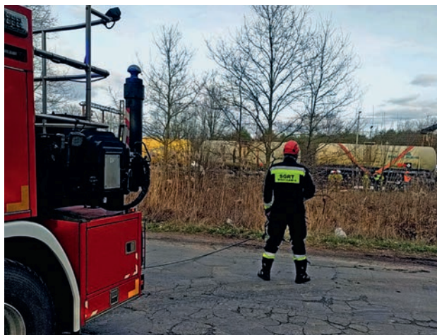
Fot. 3. Ze względu na trudności związane z dojazdem pojazd SCDż 40 z wciągarką hydrauliczną oddalony był o około 30-35 m od wagonu, który był stabilizowany
