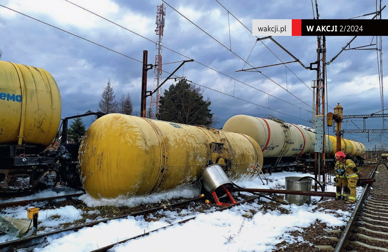
Fot. 6. Strażacy z grupy ratownictwa chemicznego cały czas monitorowali intensywność wycieku oraz wyznaczoną strefę niebezpieczną, a po ustabilizowaniu pochylonego wagonu przepompowali paliwo lotnicze z uszkodzonych wagonów
