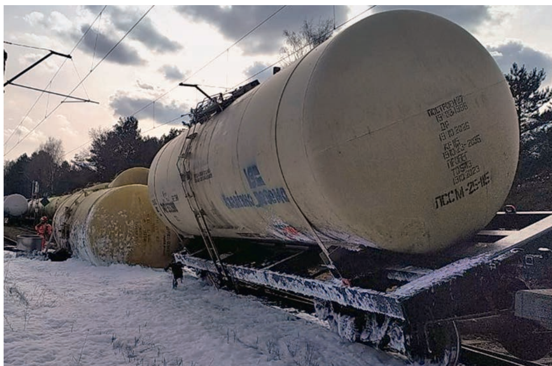
Fot. 4. Zastana na miejscu zdarzenia sytuacja – jeden wagon przewrócony na bok, a drugi pochylony – widok od drugiej strony, gdzie położono pianę gaśniczą w celu zabezpieczenia powstałego rozlewiska paliwa lotniczego
