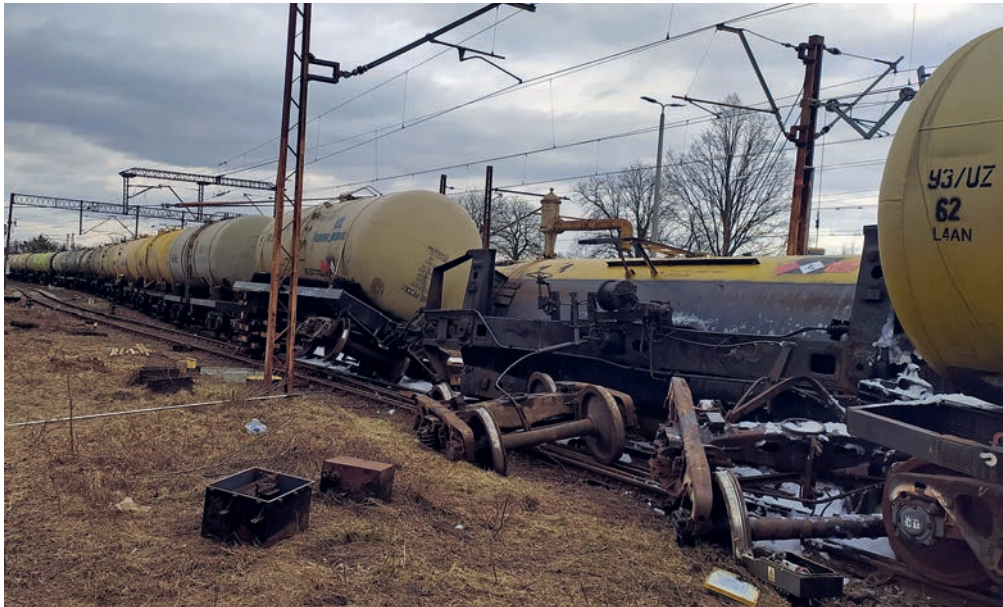
Fot. 1. Zastana na miejscu zdarzenia sytuacja – jeden wagon przewrócony na bok, a drugi pochylony, który w każdej chwili może się przewrócić
