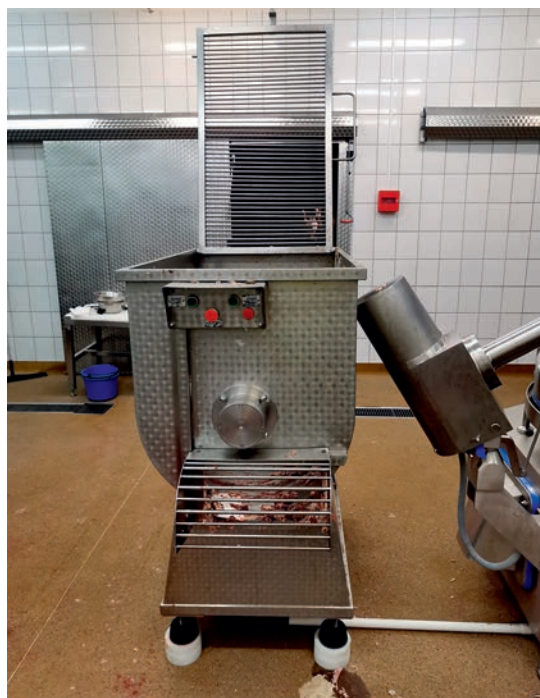
Fot. 3. Mieszalnik, przy obsłudze którego doszło do wypadku. Widoczny pulpit sterowniczy z wyłącznikiem grzybkowym
