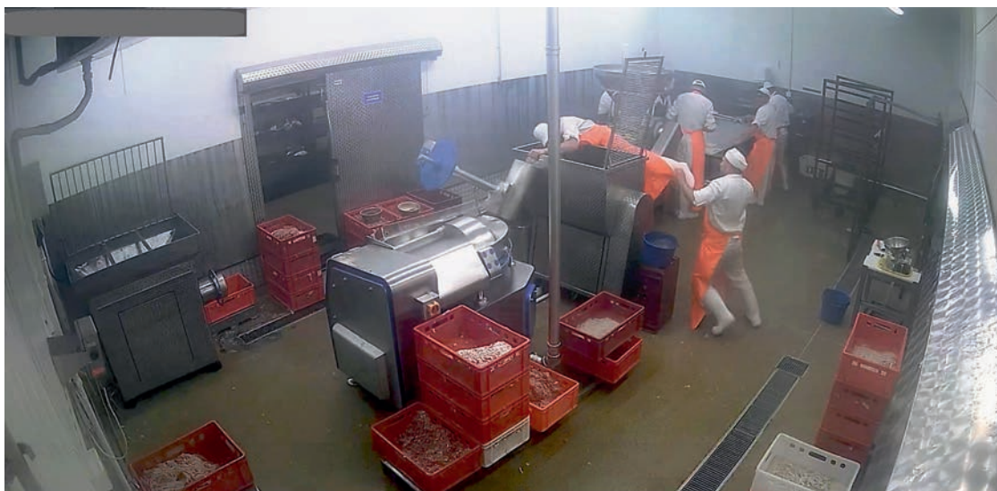
Fot. 1. Hala produkcyjna – kadr z zapisu monitoringu pokazujący moment wypadku: po lewej stronie pochylony poszkodowany z prawą ręką pochwyconą w mieszalniku, po prawej – kolega, który próbuje go odciągnąć od maszyny
