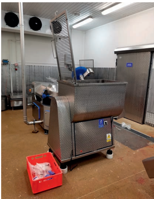
Fot. 2. Mieszalnik farszu, przy obsłudze którego doszło do wypadku. Widoczna podniesiona osłona kratowa
