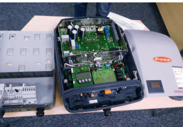
Fot. 1. Falownik instalacji PV po otwarciu obudowy
