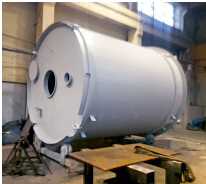
Fot. 3. Obszar wykonywania kolejnych elementów silosa na specjalnej konstrukcji z rolkami
