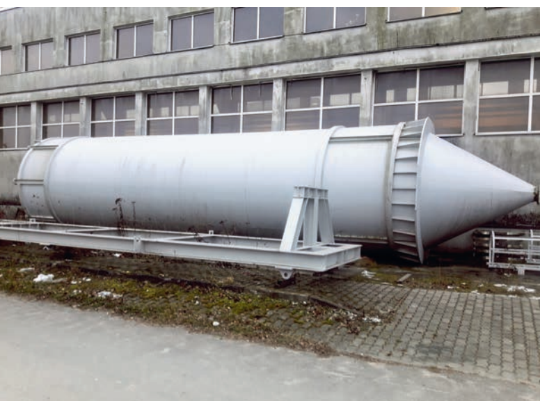
Fot. 4. Gotowy zbiornik silosa
