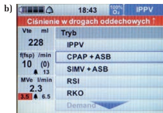
Fot. 2. Wybór opcji i ustawienie CPAP. Przy wyborze trybu CPAP należy ustawić wartość PEEP (fizjologiczna około 5 mbar) w zakresie 5-10 mbar oraz pMax na poziomie 30-35 mbar. Tryb ASB/PSV najczęściej występuje razem z funkcją CPAP, lecz jego zastosowanie nie zawsze jest możliwe z uwagi na konieczność wykupienia go jako modułu dodatkowego. Źródło: archiwum autora
